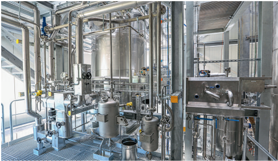
Mit der Kurzwegdestillation können unter anderem belastetes Kokos- oder Palmfett, aber auch Fischöl schonend gereinigt werden.
